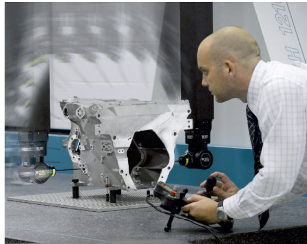
Az 5-tengelyes szkennelés gyors és gördülékeny ellenőrzést biztosít komplex munkadarabok esetében is, indexálási és tapintószár-cserélési szünetek nélkül.
